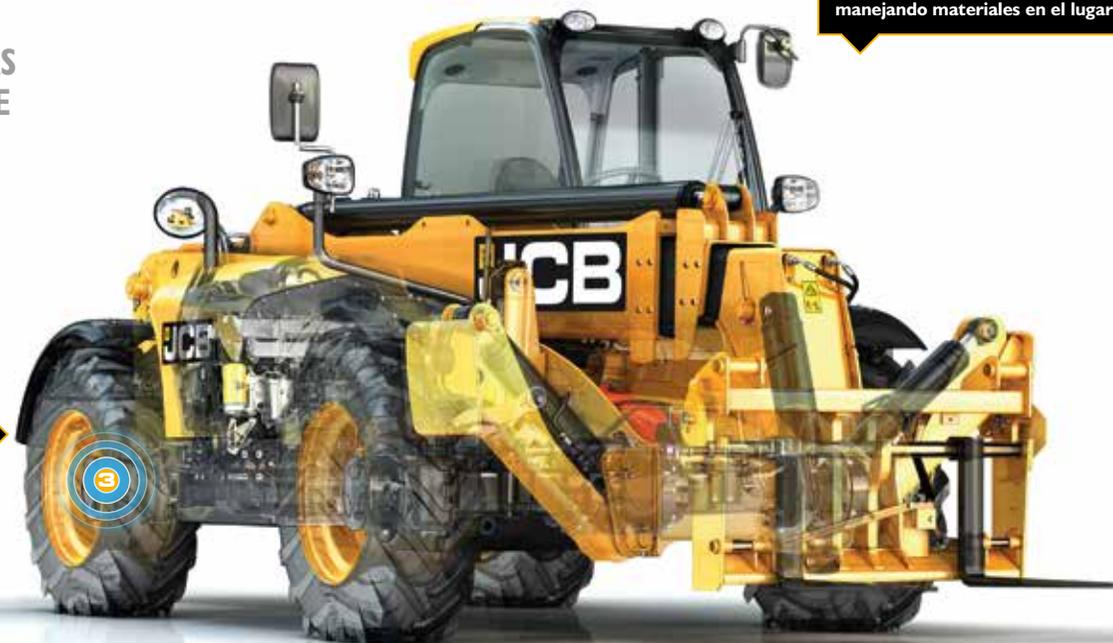
**4** El sistema de enganche rápido de JCB facilita y agiliza el cambio de aditamentos.
