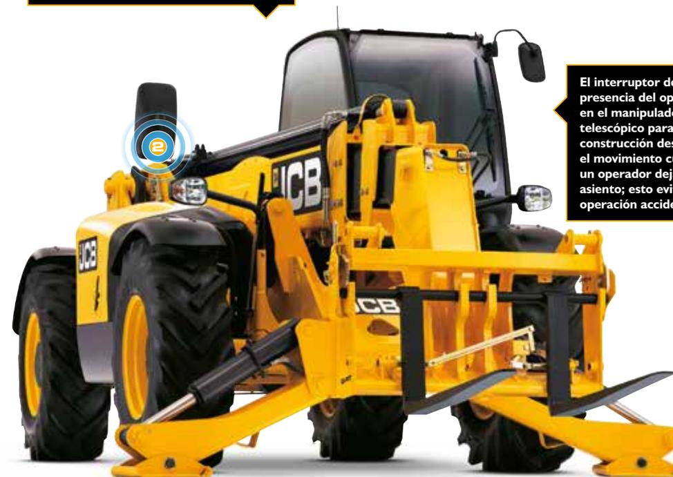
El interruptor de presencia del operador en el manipulador telescópico para construcción desactiva el movimiento cuando un operador deja su asiento; esto evita una operación accidental.
