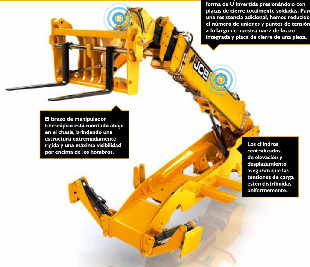
Hemos adaptado un resistente brazo con forma de U invertida presionándolo con placas de cierre totalmente soldadas. Para una resistencia adicional, hemos reducido el número de uniones y puntos de tensión a lo largo de nuestra nariz de brazo integrada y placa de cierre de una pieza.
