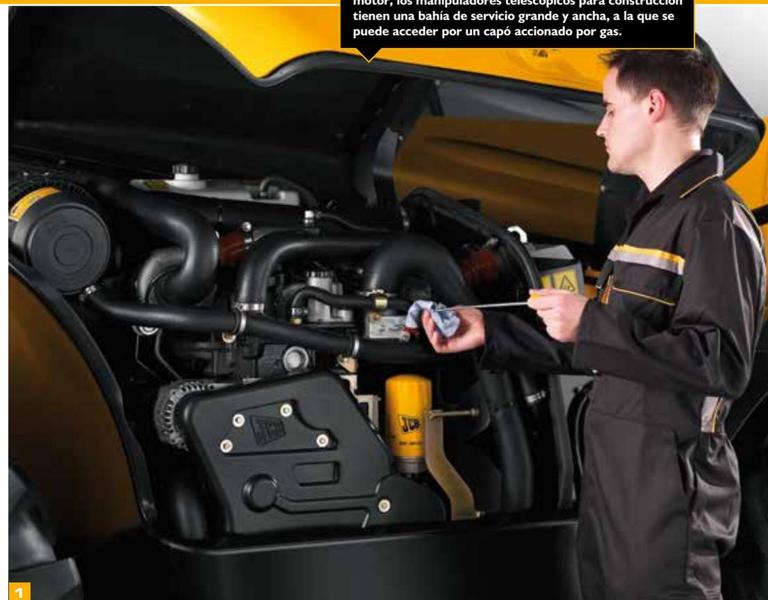
Para una inspección rápida y fácil de los 3 costados del motor, los manipuladores telescópicos para construcción tienen una bahía de servicio grande y ancha, a la que se puede acceder por un capó accionado por gas.
