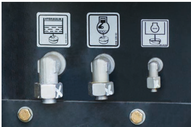
Intelligent : les consommables peuvent aisément être vidangés depuis l'extérieur.
