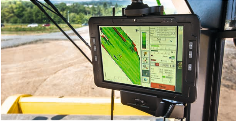
En couleurs : cartes de compactage claires avec les valeurs de compactage.
