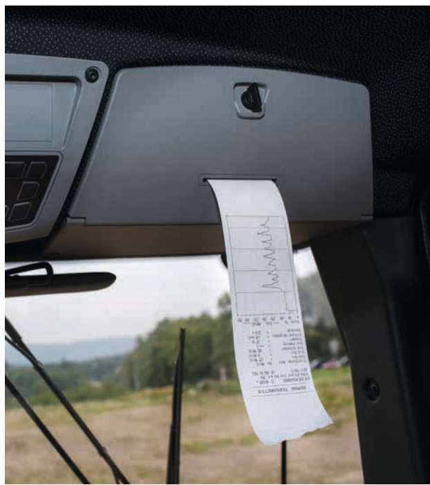
Imprimante intégrée : pour la documentation des valeurs de compactage.
