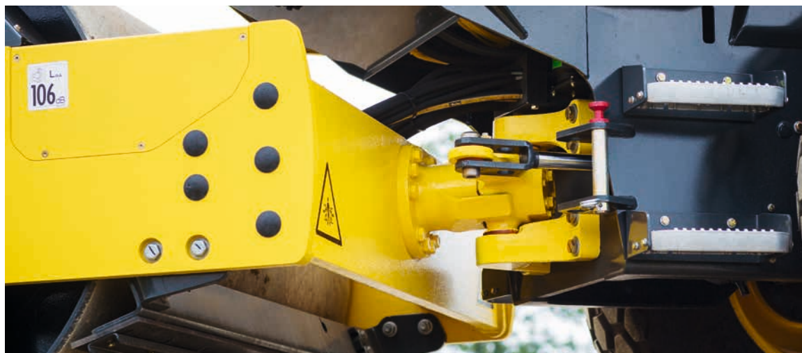
L'as de la propreté : l'articulation ne nécessite aucun entretien et la machine fonctionne sans la moindre lubrification.
