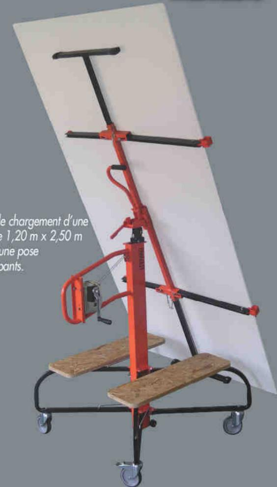
Position de chargement d'une plaque de 1,20 m x 2,50 m en vue d'une pose sous rampants.
