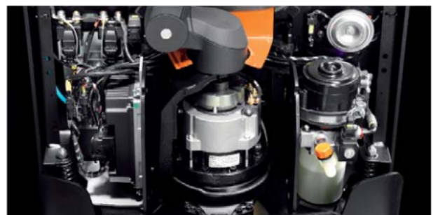
Le moteur fixe ne possède pas de faisceaux en mouvement pour plus de fiabilité
