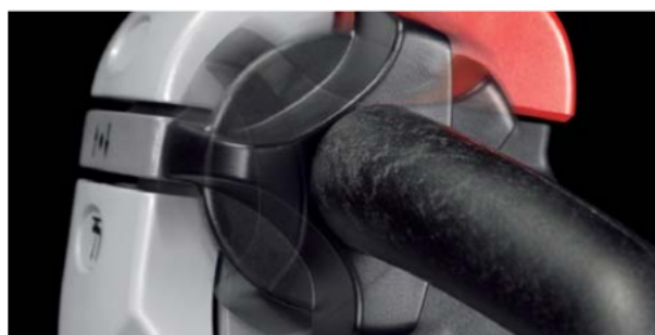
Grâce à la fonction « vitesse d'escargot », le chariot peut être manœuvré avec la poignée en position verticale
