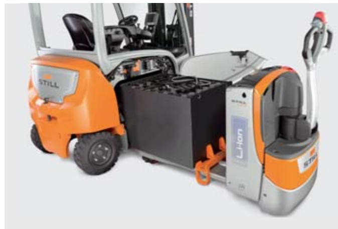
Remplacement de batterie plus sûr et plus simple par transpalette électrique.
