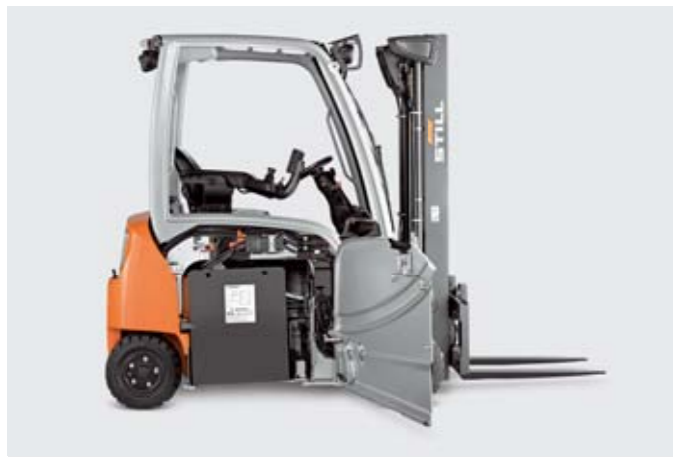
Remplacement latéral de la batterie plus rapide pour une disponibilité maximale.
