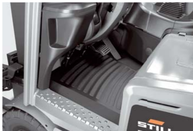
Le tapis en caoutchouc et le marchepied antidérapants augmentent la sécurité du cariste.
