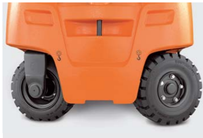
Ses deux pneus tournent à 90 degrés à gauche et à droite.
