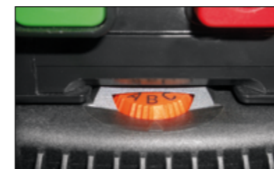
Stufenlos regelbare Geschwindigkeit von 1.800 - 4.000 U/min. Speed range 1.800 - 4.000 rpm Plage de vitesse 1.800 à 4.000 tpm Interval de velocidad 1.800 - 4.000 rpm
