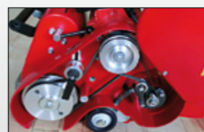
Automatische bzw. werkzeuglose Riemenspannung Automatic or tool-less belt tensioner Tension des courroies automatique voire sans outil Tensión de las correas automatica respectivamente sin herramientas
