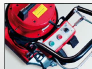
Stufenlos verstellbare Bandgeschwindigkeit Electronic belt speed control Variation électronique de la vitesse de bande Control electrónico de la velocidad de la banda
